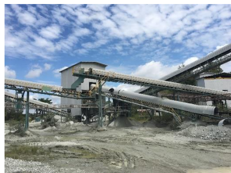
รูปที่ 2-34: การปิดคลุมสายพานลำเลียงแร่
